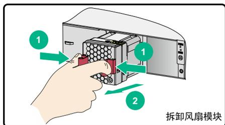
捏紧风扇模块的把手，同时沿着插槽水平缓慢地向外拉出风扇模块。
