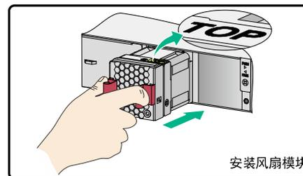
将风扇模块TOP标识朝向上方，捏住风扇模块把手，将风扇模块沿着插槽水平插入，直到风扇模块完全进入插槽，并且与背板连接器端子接触良好。
